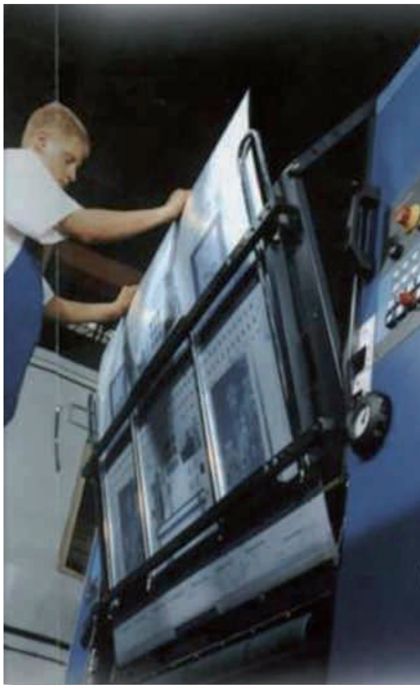
Preparação para troca automática de chapas em uma impressora offset
